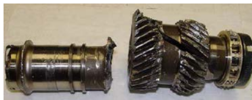
減速キヤボックスのヘリカル・インプット・キアシャフト
